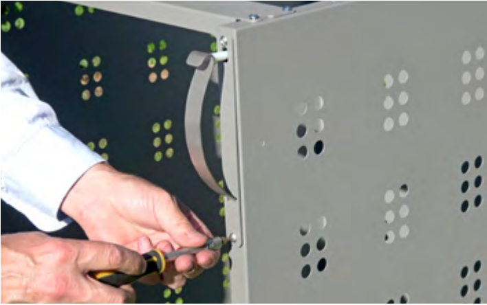
Im nächsten Schritt den Öffnungsmechanismus befestigen
