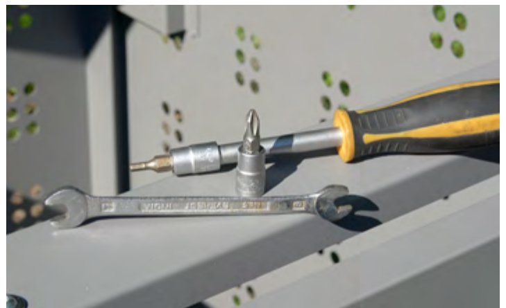
Mit wenigen Werkzeugen montiert: • Innensechskant 3 mm, • Kreuzschlitz Schraubendreher, • 8 mm Gabelschlüssel
